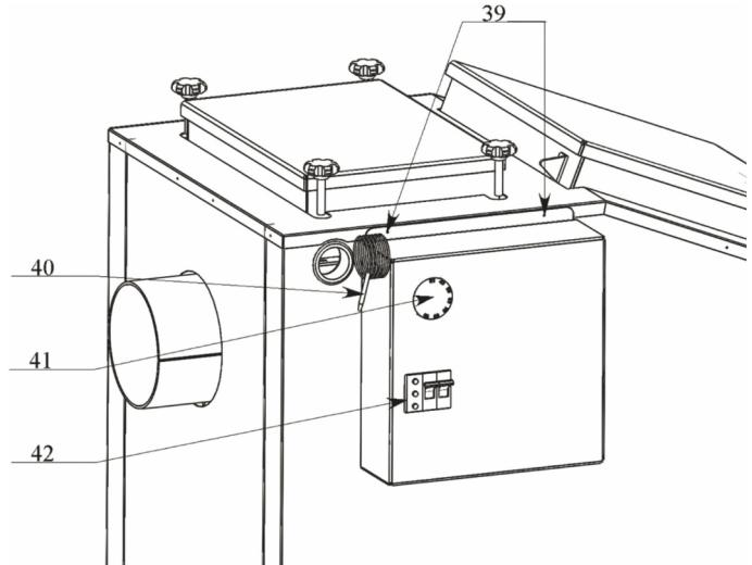
Изменяя положение регулятора  $t_1$  на реле времени 42, вы можете менять частоту работы прочистки колосников от 10 до 100 минут с шагом в 10 минут (для нормальной работы автоматической очистки мы не рекомендуем устанавливать частоту очистки менее 50 минут).
