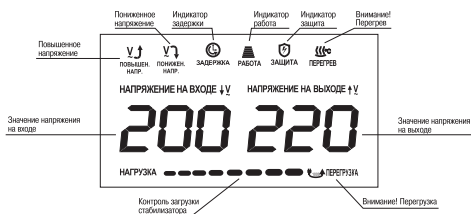
Рисунок 3. Индикация режимов работы на дисплее стабилизатора.
